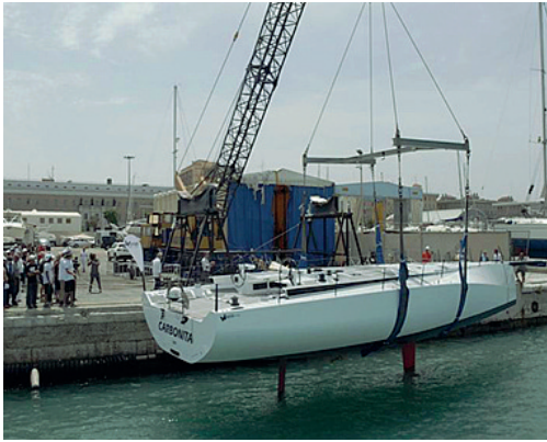
Il Neo 570 c, 18 metri, è realizzato in fibra di carbonio
